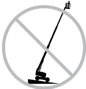
如果臂杆下降时倾斜警报器鸣响：不要超出水平面延伸、旋转或升起臂杆。提升平台之前，把机器移动到坚固、水平的地面上。
