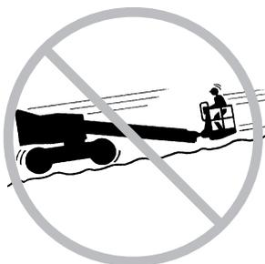
不要在任何吊车的路线上操作臂杆，除非吊车控制器已锁定，和/或已采取了防止任何潜在碰撞的防范措施。
