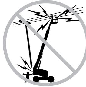
如果机器接触到带电的电线，请远离机器。切断电源前，禁止地面或平台上的人员触摸或操作机器。
