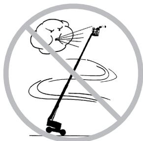
不要在强风或阵风时操作机器。不要增加平台或负载的表面面积。加大暴露在风中的面积将降低机器的稳定性。
